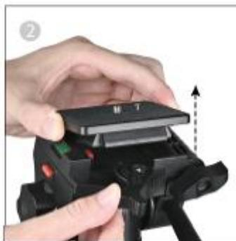
2. Levante a placa de libertação rápida e remova-a.
