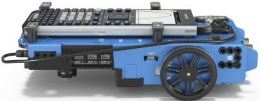
**Nota:** Com o Hub inserido, acesse às três portas para controlar os módulos de saída.
