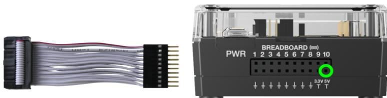
2. Guie cuidadosamente o cabo de fita anexado através da abertura na parte traseira do Rover.
